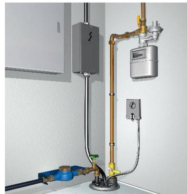
Einzel- oder Mehrspartenhauseinführungen sind Bauteile, die es ermöglichen unterschiedliche Leitungen für Strom, Gas, Wasser, Fernwärme oder Telekommunikation sicher in das Gebäude einzuführen. Mit diesen Hauseinführungen wird eine dauerhaft dichte und auch platzsparende Leitungseinführung gewährleistet. **Den aktuellen Regelwerken, das Hauseinführungen gas- und wasserdicht herzustellen sind, wird hiermit entsprochen.**
